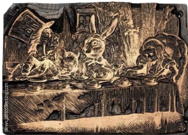
riu preservar as matrizes originais em madeira, encomendando clichês de metal feitos a partir dos blocos originais, num processo chamado eletrótipo, que daria origem a matrizes metálicas mais resistentes para a impressão em larga escala.
